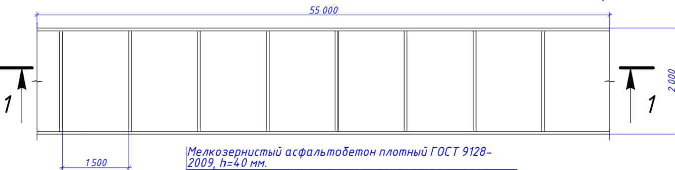
Мелкозернистый асфальтобетон плотный ГОСТ 9128-2009, h=40 мм.
