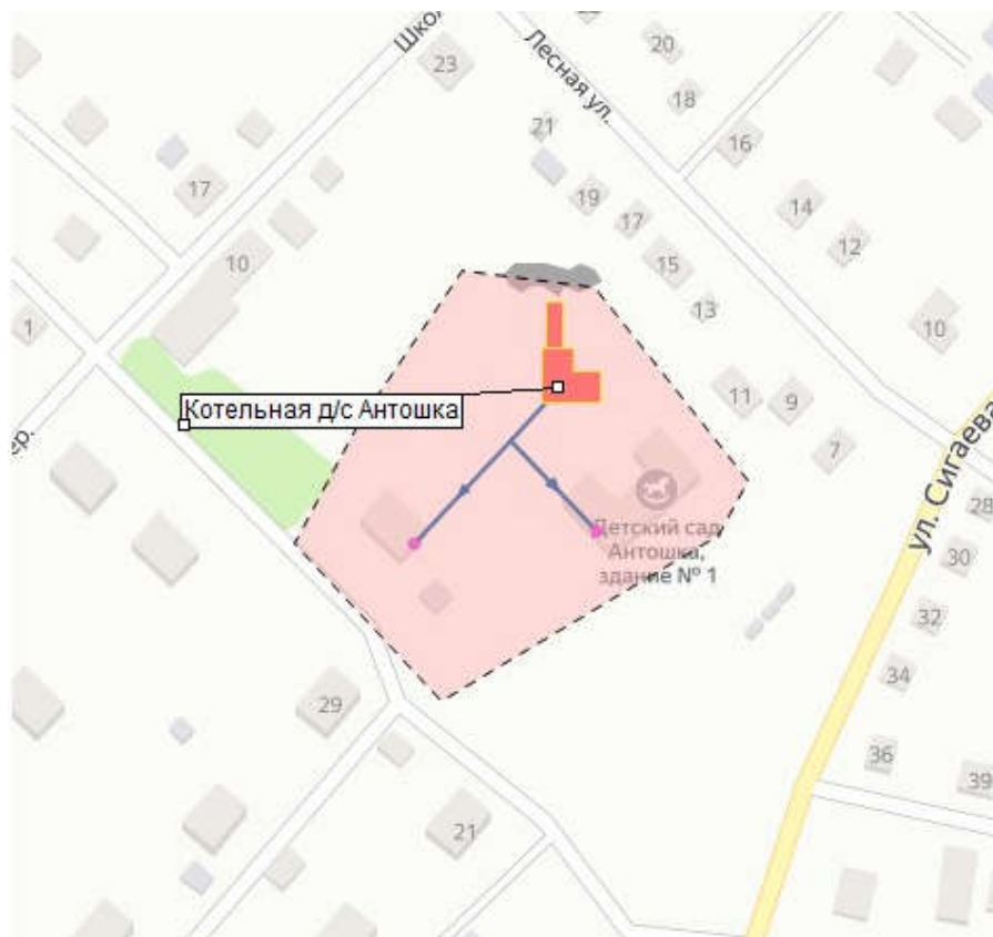
Рисунок 15 Зона действия котельной
