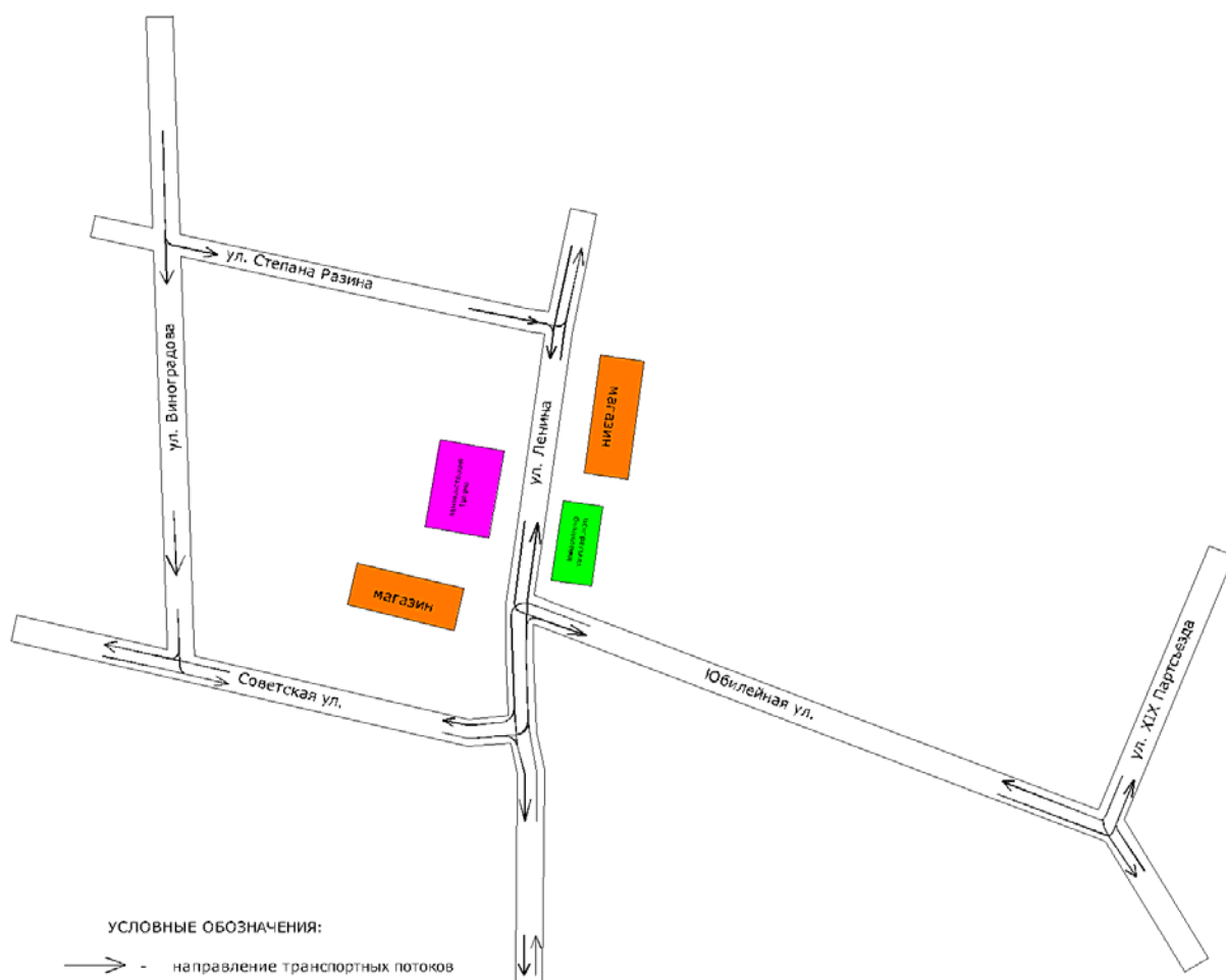
Рисунок 3.12 – Предлагаемая организация движения транспортного узла ул. Ленина – Юбилейная ул.
