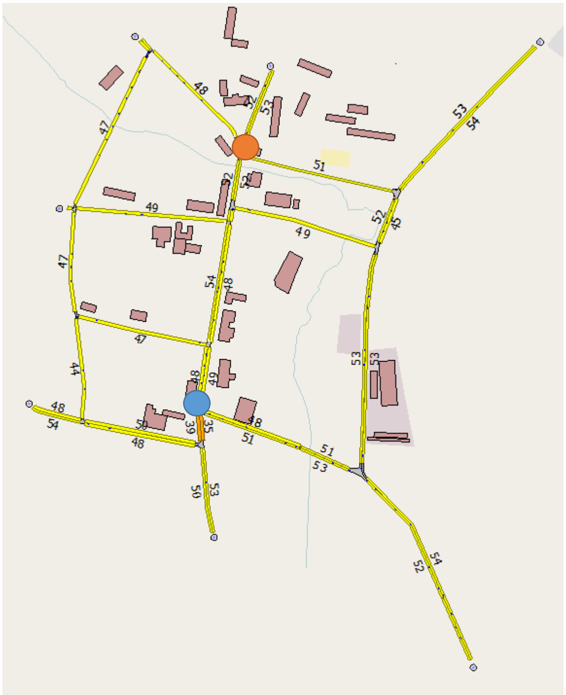
Рисунок 3.20 – Фрагмент моделирования предлагаемой схемы ОДД с картограммой средней скорости на УДС в утренний «пиковый» период времени
