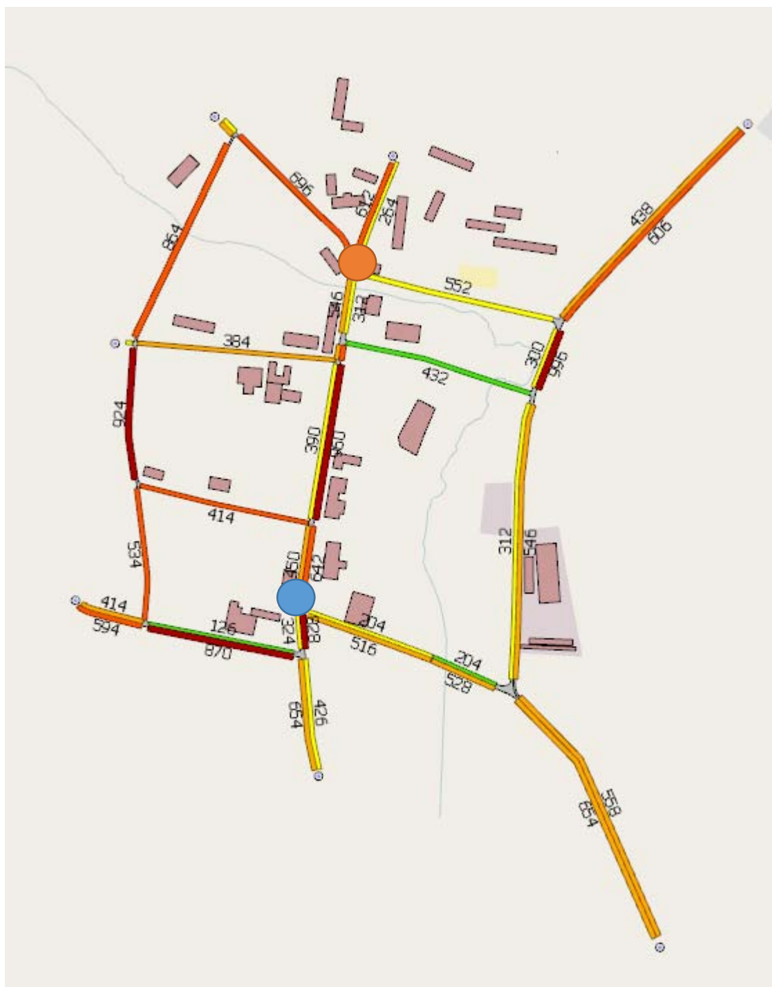
Рисунок 3.23 – Фрагмент моделирования предлагаемой схемы ОДД с картограммой расчетной пропускной способности УДС в вечерний «пиковый» период времени
