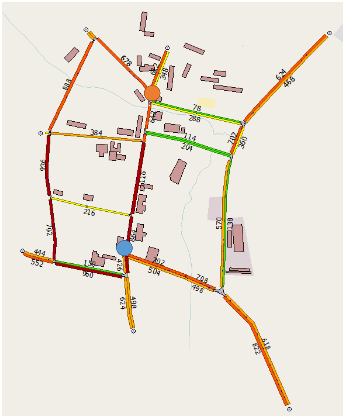
Рисунок 3.21 – Фрагмент моделирования существующей схемы ОДД с картограммой расчетной пропускной способности УДС в вечерний «пиковый» период времени
