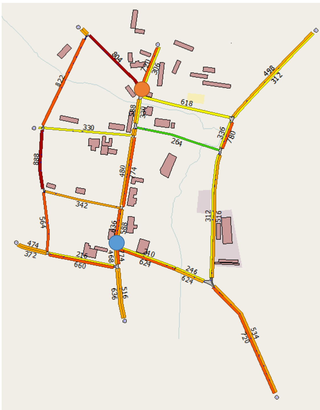
Рисунок 3.19 – Фрагмент моделирования предлагаемой схемы ОДД с картограммой расчетной пропускной способности УДС в утренний «пиковый» период времени
