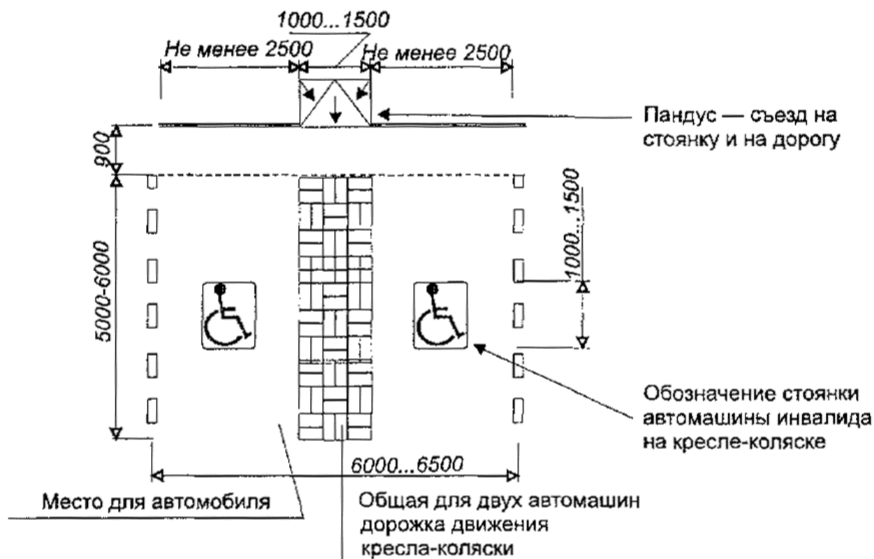
Рисунок 3.32 – Схема обустройства парковки для инвалидов
