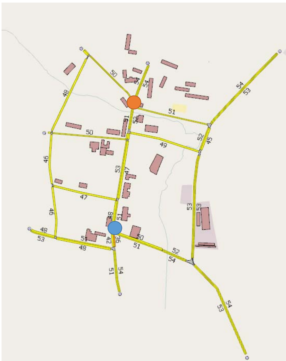
Рисунок 3.24 – Фрагмент моделирования предлагаемой схемы ОДД с картограммой средней скорости на УДС в вечерний «пиковый» период времени
