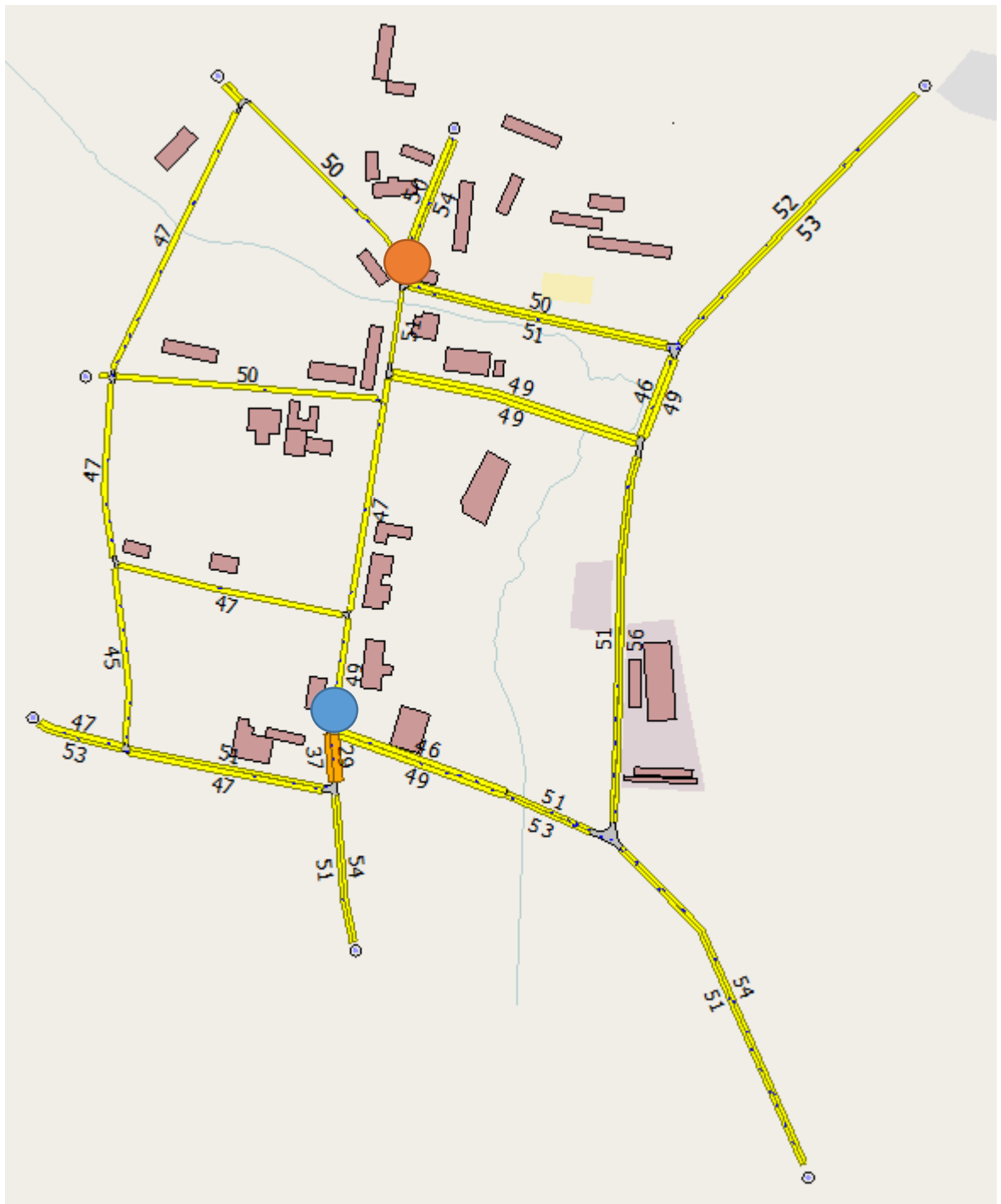
Рисунок 3.22 – Фрагмент моделирования существующей схемы ОДД с картограммой средней скорости на УДС в вечерний «пиковый» период времени
