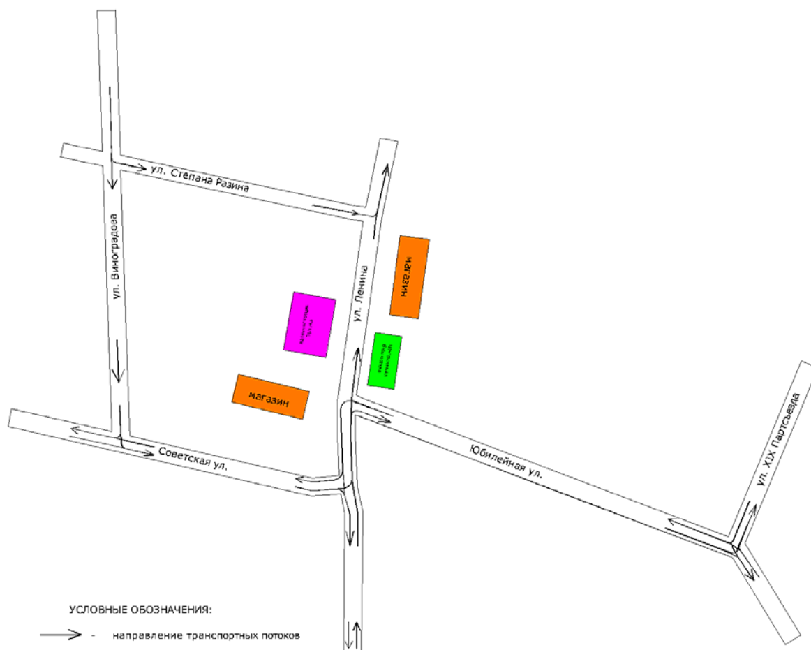
Рисунок 3.11 – Существующая организация движения транспортного узла ул. Ленина – Юбилейная ул.
