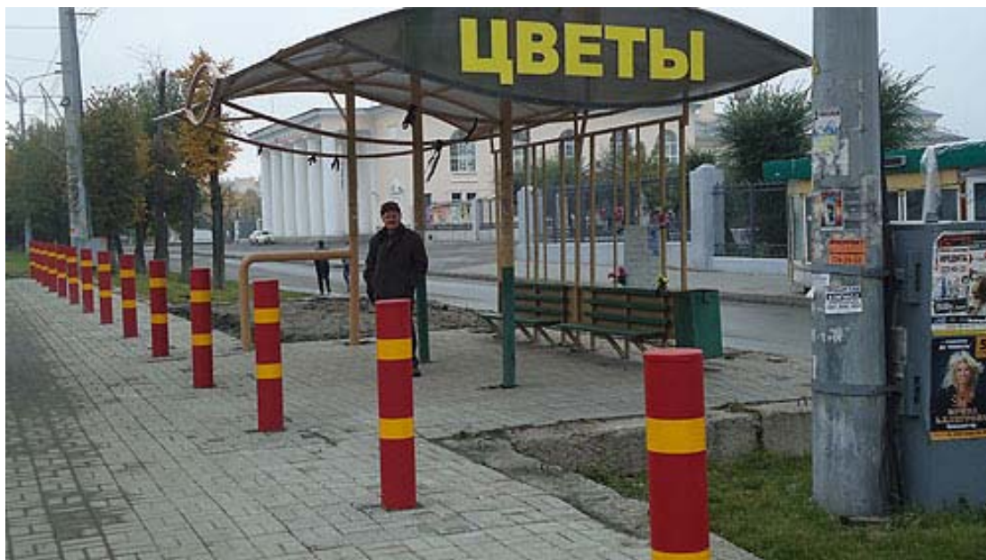
Рисунок 3.38 – Пример обустройства остановочного пункта ограждающими устройствами
